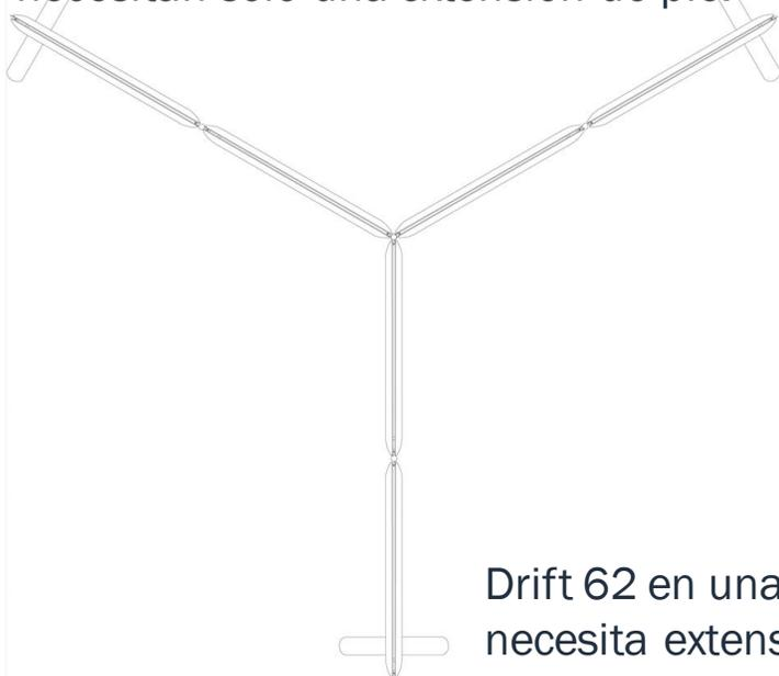
Drift 62 en una conexión de 3 x 120° necesita extensiones de pie en cada segundo elemento
