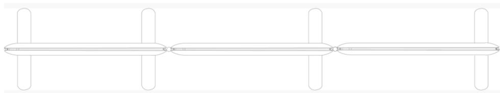
Los elementos Drift 62 se pueden unir linealmente con soportes de conexión. El primer elemento necesita dos extensiones de pie. Todos los elementos adicionales necesitan sólo una extensión de pie.
